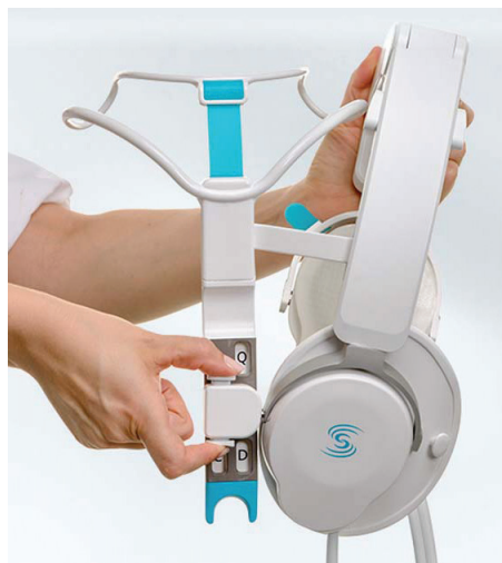
Рис. 4. Узел датчиков и инструмент для регулировки их положения
